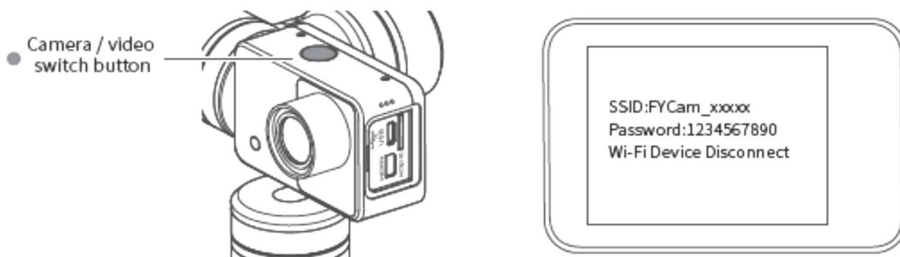
2. Attivare il Wi-Fi sul vostro dispositivo, scegliere di connettersi alla rete indicata sullo schermo della Action Cam, inserire la password e avviare la connessione.
